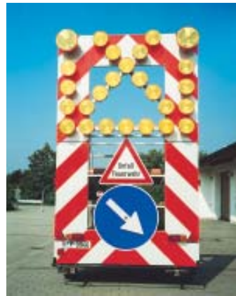
Bild 6b VSA betriebsbereit
